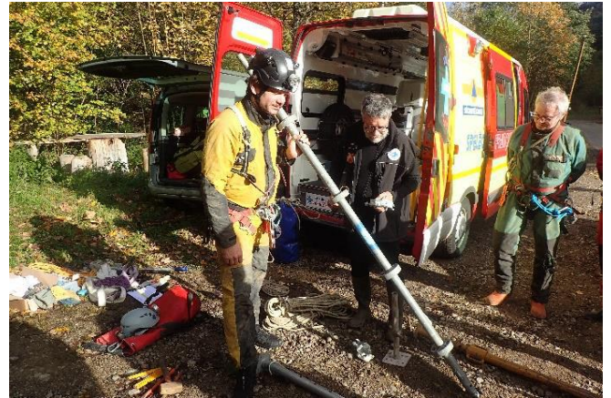
Quelques exemples du matériel utilisé – Etais de maçon de différentes qualités, tube Multi D, étrésillon, avec l'échelle.
