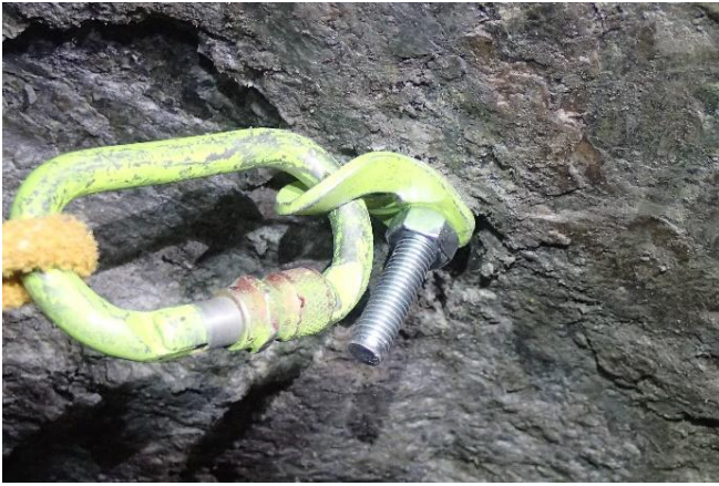
Résultats des tests, le spit était bien expansé, la tige filetée de 12mm plantée sur 25cm tient bon, la plaquette moins.
